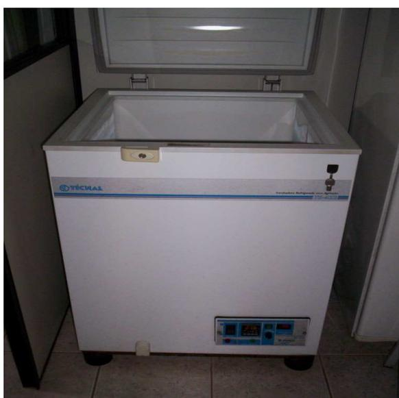
Figura 4 – Incubadora refrigerada com agitação.
