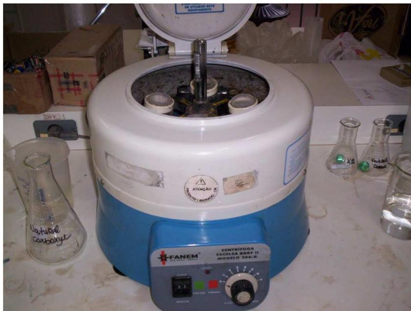
Figura 5 – Centrífuga Excelsa Baby II com as suspensões de amidos.
