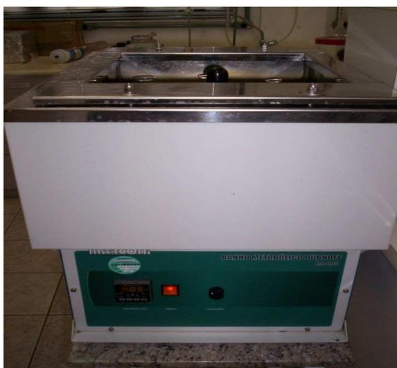
Figura 7 – Banho Metabólico Dubnoff a 40°C com as suspensões durante 4 horas.
