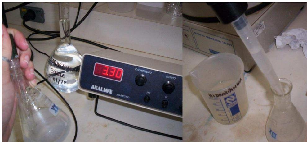
Figura 6 – Ajuste do pH da suspensão de amido seguida da adição de reagente Hidroxilamina.
